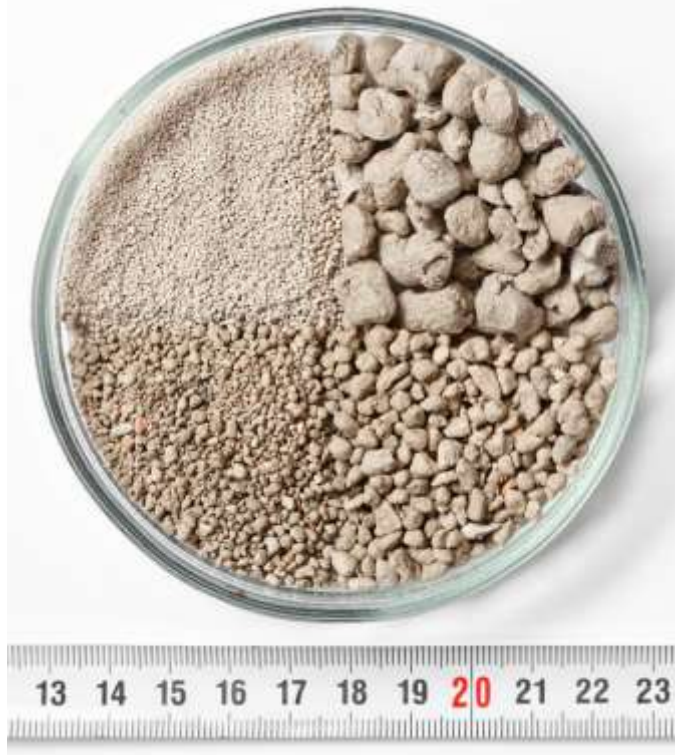
Рис 1. Гранулированный теплоизоляционный материал ДиатомИК в готовом виде
